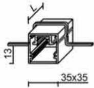
Barra a led a filo da incasso completa di cassaforma in alluminio anodizzato, ingombro massimo di 35mm, terminali in plastica. Viene fornita con 25cm di cavo bipolare per i collegamento elettrico. Lunghezza massima della barra 2000mm. Taglio a misura degli angoli di giunzione. Installazione da interno su cartongesso legno o muratura. FINITURE: POLICARBONATO OPALE SCHERMO: POLICARBONATO OPALE / TRASPARENTE
