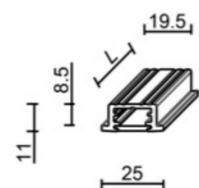
Barra led a T a incasso da parete / soffitto, ingombro massimo 25mm, terminali in plastica di forma rotonda o quadrata.
