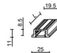
Barra led a T resinata da incasso, parete / soffitto / terra, ingombro massimo 25mm, terminali in plastica di forma rotonda o quadrata. Viene fornita con 25cm di cavo bipolare per il collegamento elettrico.
