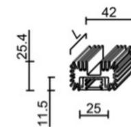
Barra led a Riccio da appoggio parete / soffitto o sospensione a singola o doppia emissione con ingombro massimo 42mm, terminali in acciaio.
