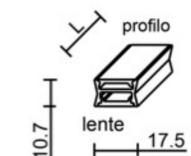
Barra appoggio parete / soffitto, con ingombro massimo 17,5mm, terminali in plastica.
