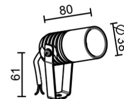
Proiettore a led anti abbaglio in alluminio da appoggio a parete / soffitto / terra.
