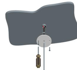
**Fissare il rosone tramite viti diametro massimo 4mm.**
