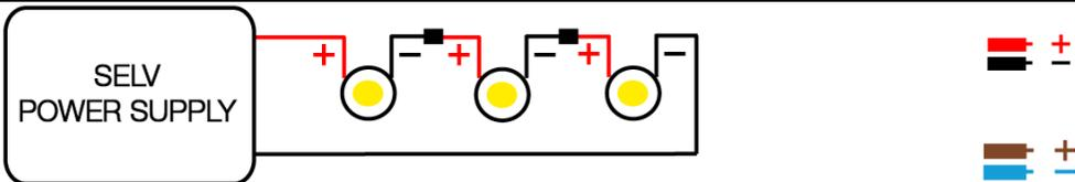
• **ATTENZIONE:** Prima di iniziare i collegamenti elettrici assicurarsi che l'alimentatore non sia in tensione, il collegamento alla rete elettrica deve essere eseguito solamente dopo aver completato il cablaggio di tutti i componenti. Il mancato rispetto di questa avvertenza compromette irrimediabilmente la sorgente luminosa. L'installazione richiede personale qualificato.
