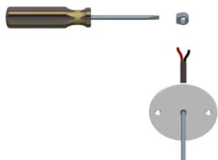
**Determinare la lunghezza della sospensione e fissare il fermacavo sul cavo della sospensione avvitando la vite**
