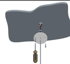
Fissare il rosone tramite viti adatte al supporto
