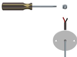
Determinare la lunghezza della sospensione e bloccare il fermacavo sul cavo di sospensione avvitando la vite
