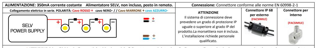
ATTENZIONE: Prima di iniziare i collegamenti elettrici assicurarsi che l'alimentatore non sia in tensione, il collegamento alla rete elettrica deve essere eseguito solamente dopo aver completato il cablaggio di tutti i componenti. Il mancato rispetto di questa avvertenza compromette irrimediabilmente la sorgente luminosa. L'installazione richiede personale qualificato.
