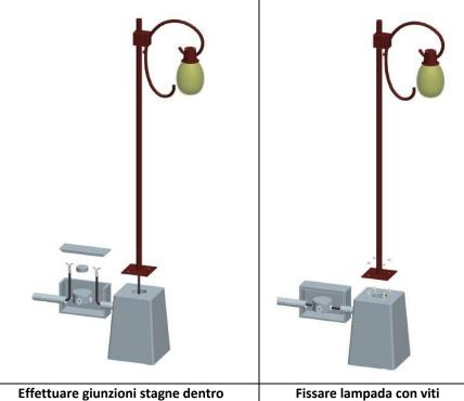
Connessione: Connettore conforme alle norme EN 60998-2-1
