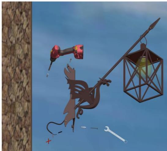
Esecuzione fori per viti diametro 6mm (max 8mm)
