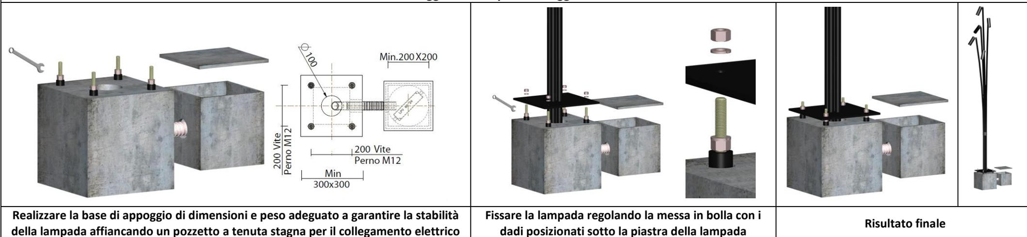
Realizzare la base di appoggio di dimensioni e peso adeguato a garantire la stabilità della lampada affiancando un pozzetto a tenuta stagna per il collegamento elettrico
