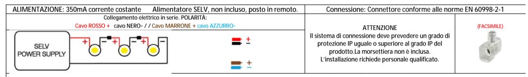
• ATTENZIONE: Prima di iniziare i collegamenti elettrici assicurarsi che <u>l'alimentatore non sia in tensione</u>, il collegamento alla rete elettrica deve essere eseguito solamente <u>dopo aver</u> <u>completato il cablaggio di tutti i componenti</u>. Il mancato rispetto di questa avvertenza compromette irrimediabilmente la sorgente luminosa. L'installazione richiede personale qualificato.
