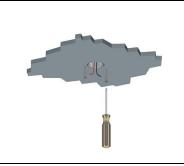
Inserire la cassaforma e fissarla sul cartongesso con due viti autoforanti
