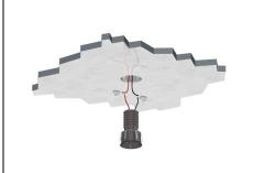
Effettuare il collegamento elettrico rispettando la polarità e inserire il faretto in sede
