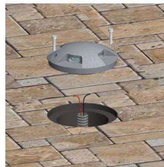
Effettuare il collegamento elettrico stagno IP68 rispettando la polarità dei cavi
