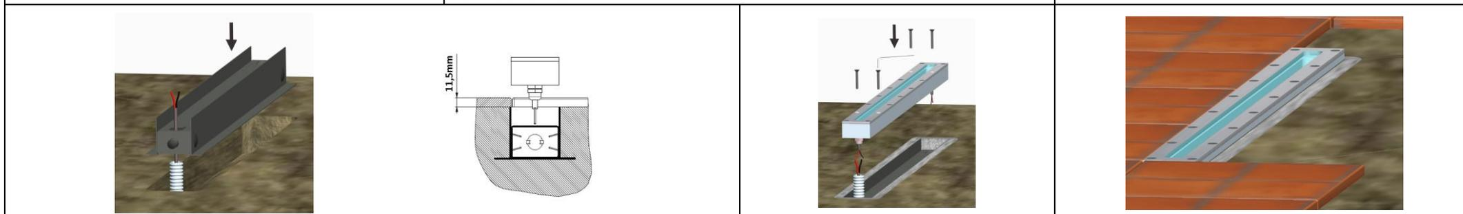
Per posizionare il corpo illuminante a filo con il pavimento considerare una distanza di 11.5 mm dal piano finito del pavimento al bordo della cassaforma
