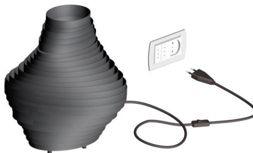
COLLEGAMENTO 220V AC tramite interruttore e spina
