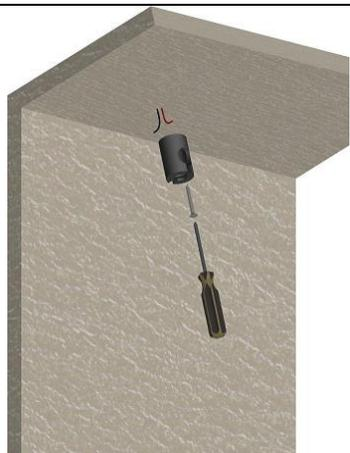
Fissare il supporto della lampada al soffitto per mezzo di una vite a testa svasata di diametro massimo 5mm (non fornita) adatta al supporto
