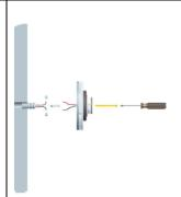
Effettuare giunzioni elettriche rispettando la polarità dei cavi e fissare supporto a parete
