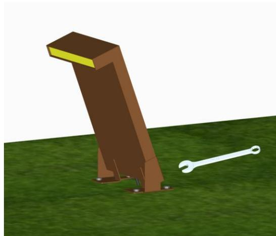
Fissaggio al supporto tramite viti diametro massimo 8mm.
