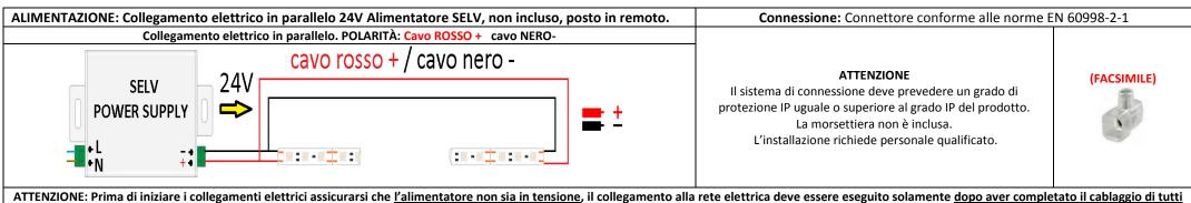
ATTENZIONE: Prima di iniziare i collegamenti elettrici assicurarsi che <u>l'alimentatore non sia in tensione</u>, il collegamento alla rete elettrica deve essere eseguito solamente <u>dopo aver completato il cablaggio di tutti</u>
