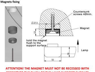
RESPECT TO THE FLUSH OF THE LAMP SUPPORT SURFACE
