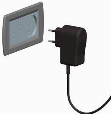
**Alimentazione del purificatore a 12Vdc
